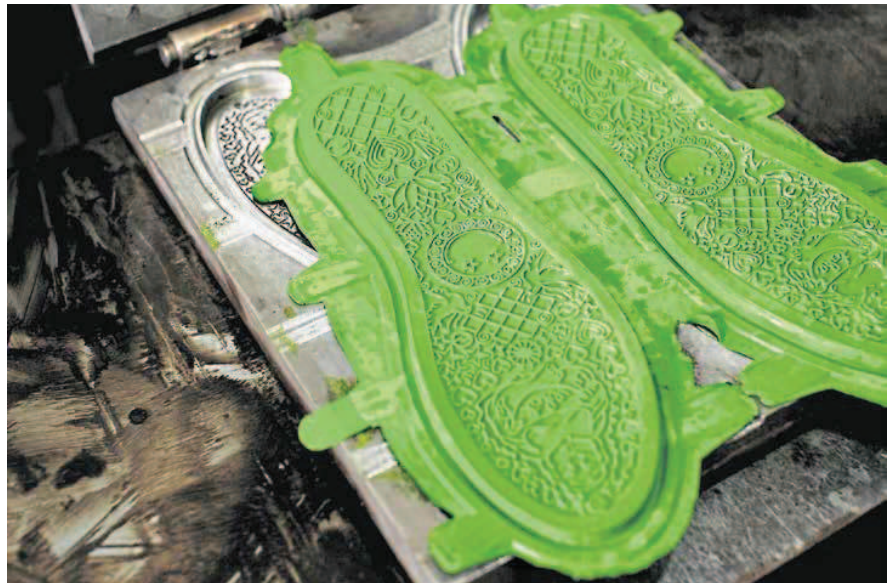
Die Sohle wird in einer Art Waffeleisen in Form gebracht Foto: Kathrin Harms/laif
