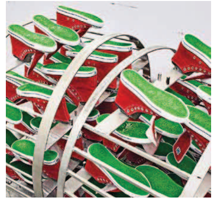
Fast fertig: Die Schuhe werden vulkanisiert Foto: Kathrin Harms/laif
