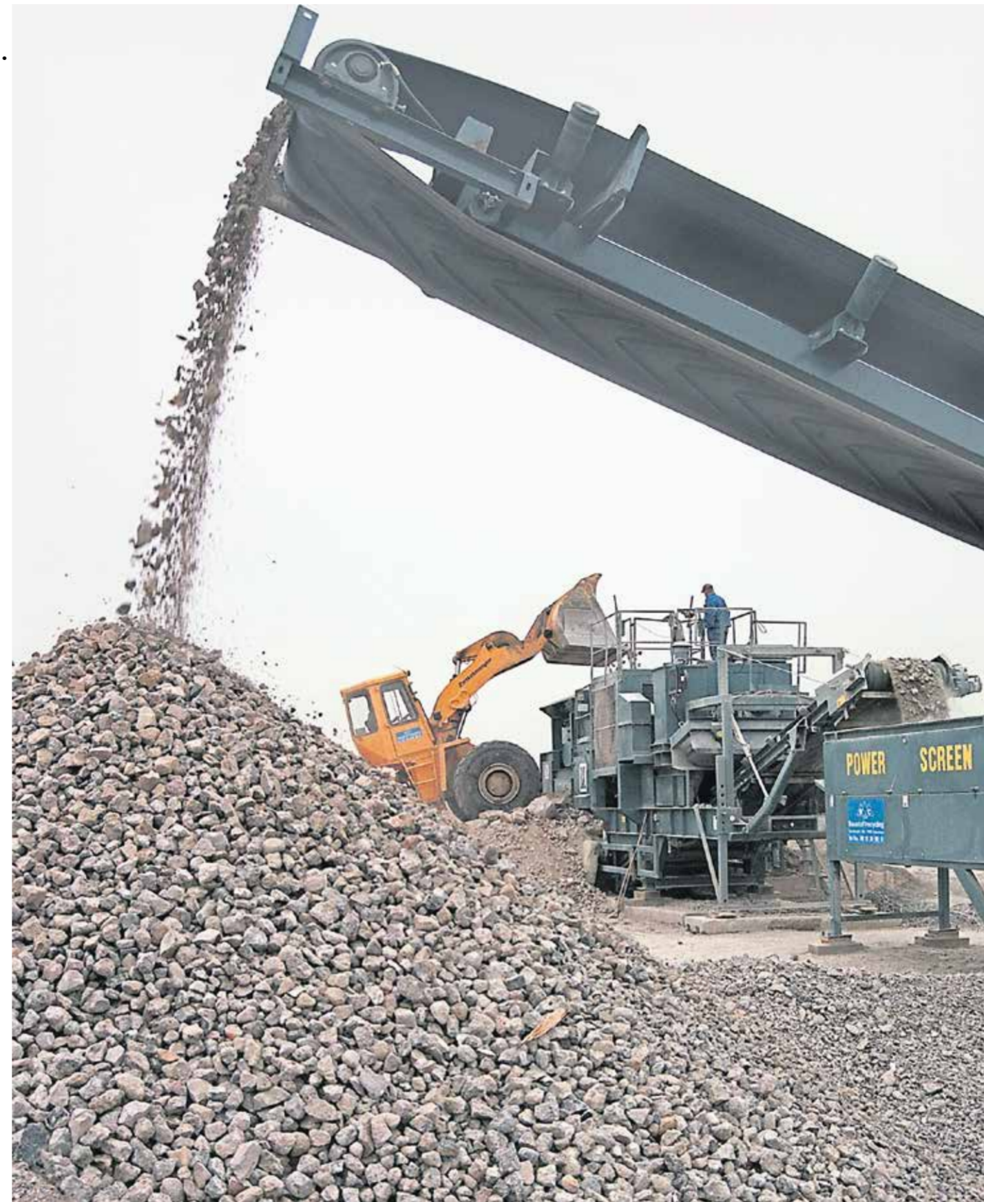
Nichts umkommen lassen: Eine Baustoff-Recyclinganlage in Daberkow im Landkreis Demmin Foto: Stefan Sauer/dpa
